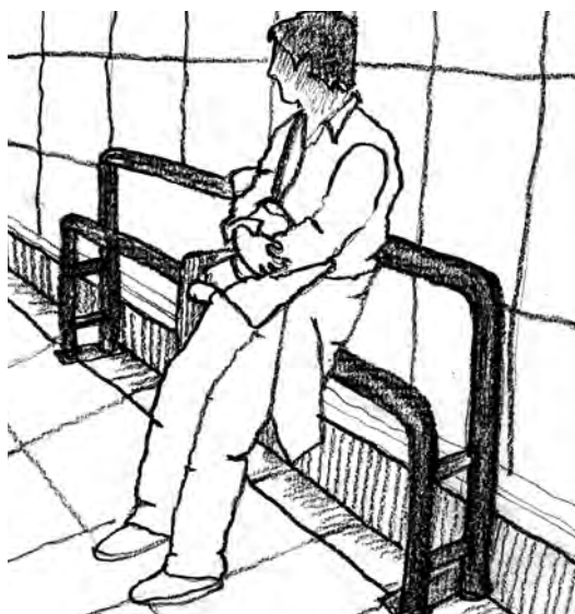
Figura 168. Prototipo de Mintra para Metro de Madrid de apoyo isquiático de dos alturas. Fuente: Socytec (dibujo).
