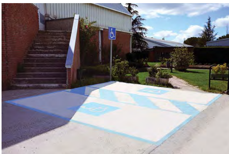
Figura 95. Plazas de aparcamiento reservadas para personas de movilidad reducida. Fuente: Socytec (fotografía).
