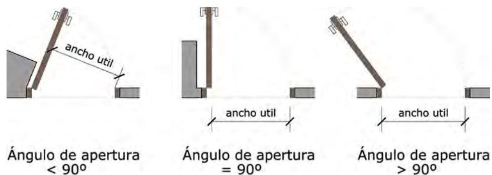
Figura 47. Ancho útil de una puerta. Diferentes situaciones. Fuente: Socytec (dibujo).
