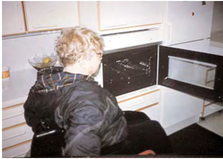
Figura 189. Detalle de un horno con puerta de apertura lateral (como en los microondas), lo que facilita su apertura y cierre. Fuente: Socytec (fotografía).
