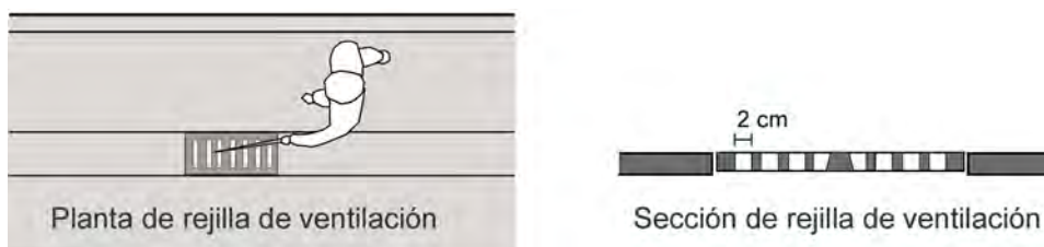
Figura 117. Rejillas de ventilación. Fuente: Socytec (dibujo).
