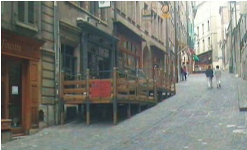
Figura 137. Meseta horizontal en calle de fuerte pendiente. Fuente: Socytec (fotografía).
