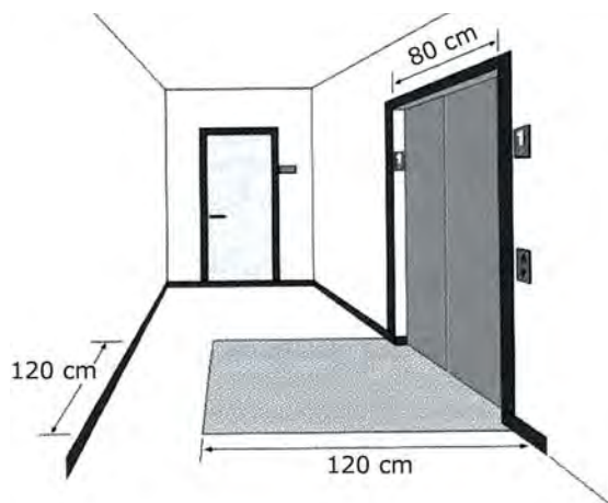
Figura 235. Dimensiones de un rellano frente al ascensor. Fuente: Socytec (dibujo).
