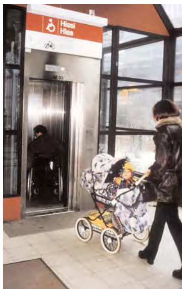
Figura 242 y 243. Ascensores: Cabina con dimensiones practicables y botonera sensible al tacto, inadecuada para personas invidentes
