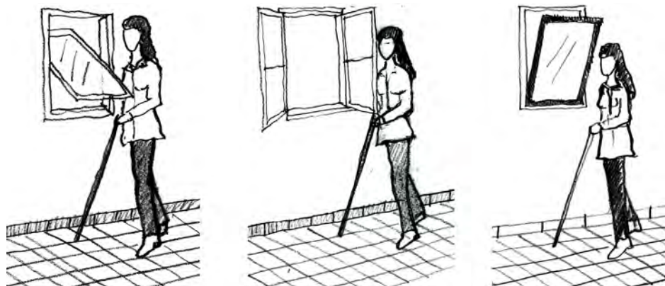
Figura 229. Ejemplos de ventanas inadecuadas. Fuente: Socytec (dibujo).
